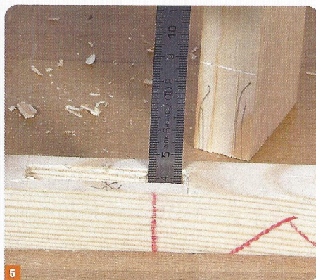
5 Contrôlez la profondeur de la mortaise.
