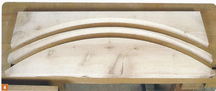
4 La cale est sciée, on voit nettement la chute de largeur irrégulière.
