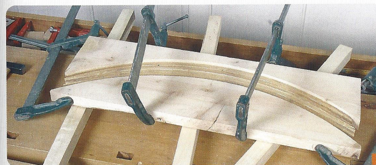
7 Finissez le serrage central et ajoutez des serre-joints aux extrémités. Retendez encore une fois tous les serre-joints.
