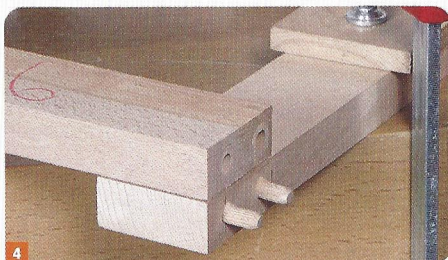
4 Longeron avec les tourillons et les perçages réalisés dans la traverse.
