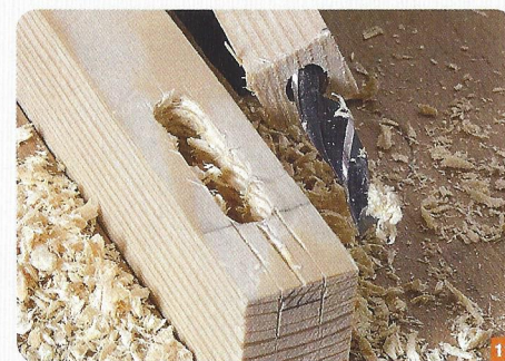
9 Complétez le traçage par un renfort d'épaulement ainsi que par un trait d'axe de la mortaise. Vous utiliserez ce trait pour positionner la mèche munie d'une pointe de centrage.
