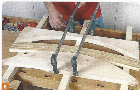
5 Préparez un lit de collage (pour pouvoir le cas échéant placer des serre-joints sous la pièce à coller et pour éviter de salir votre plan de travail avec la colle qui sortira inmanquablement des joints). Encollez les deux faces des lames à assembler (utilisez une colle à temps ouvert long) et installez-les entre les cales de serrage.
